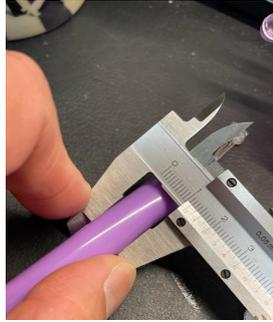
シャフトの割れた部分を切断して、シャフト径を測定(11mm)
